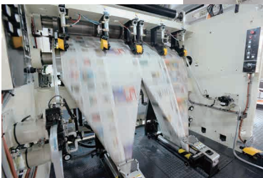
2時間弱で20万部を印刷する最新型の高速輪転機。カラーページは最高24ページを印刷できる
