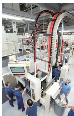
刷り上がった新聞はキャリアで発送部門に運ばれる。工程はすべてコンピューターで集中管理されている
