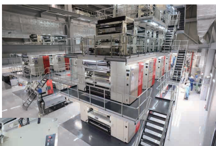
2時間弱で20万部を印刷する最新型の高速輪転機。カラーページは最高24ページを印刷できる
